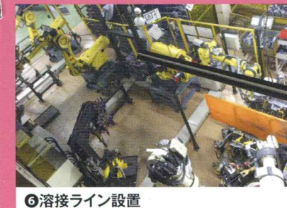
⑥溶接ライン設置
