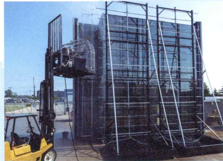
エリー AP社による ユニットカーテンウォール性能検証の様子
