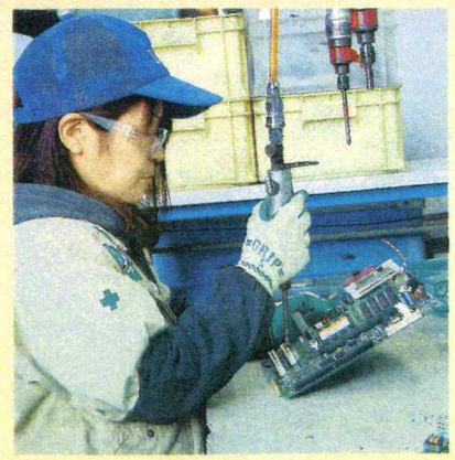
手解体・選別 手解体により素材別、品質別に解体を行います。良い原料はより良いものへリサイクル困難な物は選別・解体をすることによってリサイクルの容易な物へ変えていきます。
