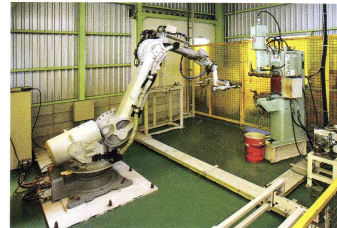
SW溶接設備
