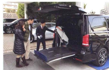
「片アーム式車いすリフト」を装着したメルセデス・ベンツ【Vクラス】
