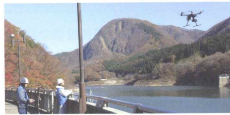
鳴子ダム総合点検におけるUAV(無人ヘリコプター)を利用したアーチダム表面劣化状況調査 <国土交通省東北地方整備局>
