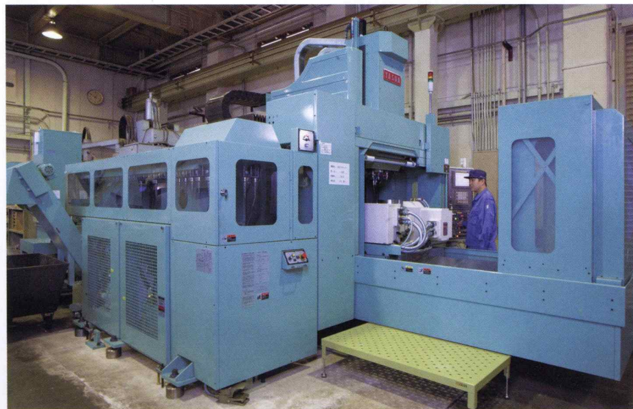
マシニングセンター 冷間鍛造金型直彫加工(高硬度HRC60材加工) タービンブレード完成加工
