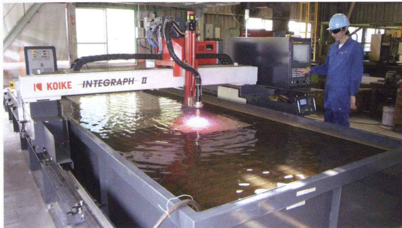
NCプラズマ切断機
