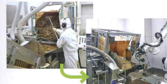
2019年12月に竣工した茨城工場第3SD棟は全工程オートメーション化。かき出す作業も省人化・ロボット化を実現
