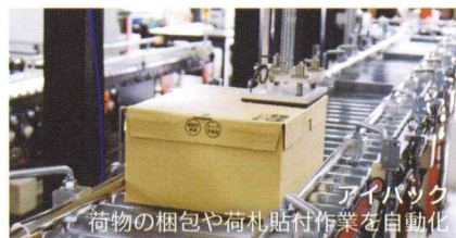
ボックスオンデマンド 商品の寸法に合った箱を自動で作成
