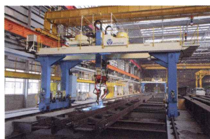
梁溶接ロボット
