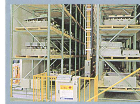
金型ラック設備 膨大な数の金型はオートメーションのラック設備に収め、コンピュータによって管理しています。キーボード入力をするだけで、指示どおりの金型が自動で運ばれてきます。
