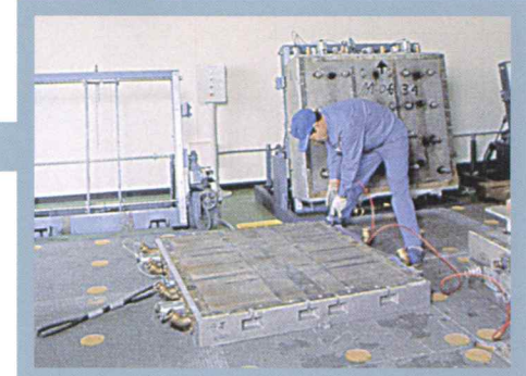
金型メンテナンス 確かな製品づくりのため、ねじしめ、ゴミ取り等、金型をメンテナンスします。
