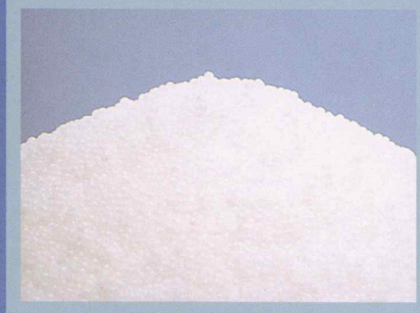
発泡スチロールの原粒 発泡スチロールの“素”。 水素と炭素の高分子化合物で中には発泡ガスが入っています。
