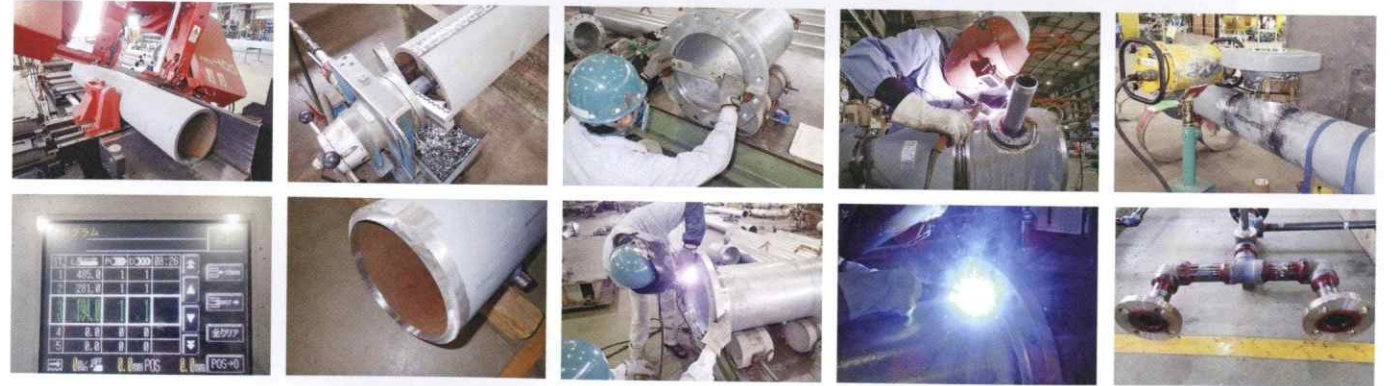
パイプ切断 → 開先加工 → 仮組 → 溶接 → 非破壊検査 ※第三者機関へ委託
