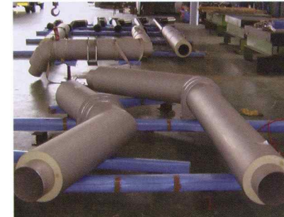
現場状況に最適な寸法と角度での一体製作
