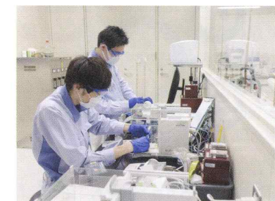
標準品や試薬の計量を行います。セミマイクロ天秤は0.00001g単位を測ることができます。
