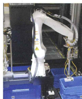
「TBC広島」のピース品(包装単位商品)ピッキングロボット。「TBC埼玉」のものより小型化、省電力化された
