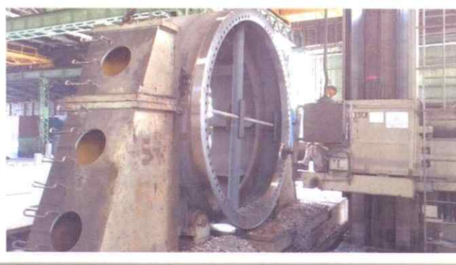
横中くりフライス盤 (クレーンポスト加工中)
