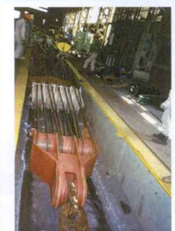
滑車引張試験 最大150 t 引張試験可能 NK認定有り
