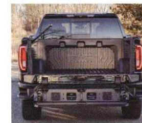
米国のゼネラルモーターズ社のピックアップトラックに採用された、帝人の熱可塑性炭素繊維複合材料「Sereebo」
