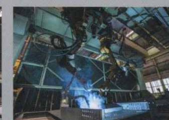
橋梁パネル溶接ロボット 鉸桁、箱桁などの橋梁部材を溶接するアーク溶接ロボット。
