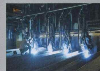
門型10電極自動溶接機 一度に10箇所の溶接ができる自動溶接機。
