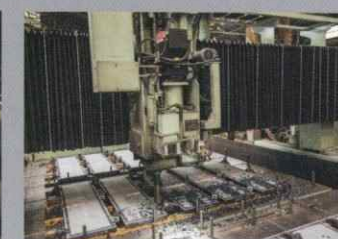
NCガンリー形高速ドリル 橋梁・鉄骨等大型部材への孔明加工に使用 する高速穿孔機。
