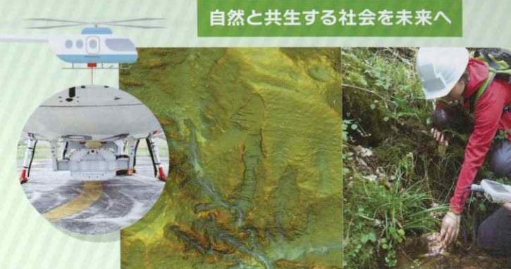
左：レーザーを搭載したヘリコプター 中央：レーザー航測でそのエリアにどれくらいの高さの木がどれくらいの密度で生えているのか立体的に把握 右：山間部で流量や水質を調査
