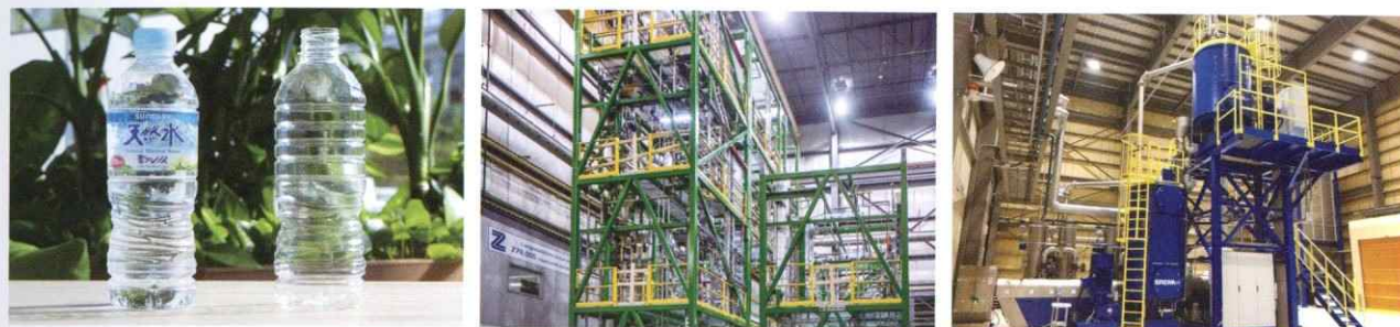
左：植物由来原料を30%使用した「サントリー天然水」のボトル(左)と植物由来原料100%を使用したペットボトルの試作品(右) 中央：植物由来原料のペットボトルを製造する実証プラント 右：「FtoPダイレクトリサイクル技術」を用いた製造ライン
