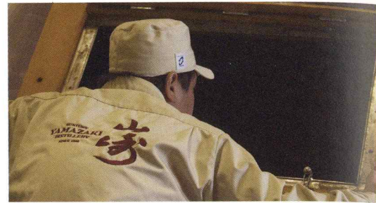
仕込みや発酵に大きく影響する水 ウイスキーの「仕込み」を行う仕込槽。この中で粉碎した麦芽と温めた仕込み水を混ぜると、麦芽中の酵素の働きででんぷんが糖に変わります。これを濾過した麦汁をアルコール分約7%のもろみに変えるのが次の「発酵」の工程。山崎蒸溜所ではステンレスと木桶の二種類の発酵槽を使用しています。
