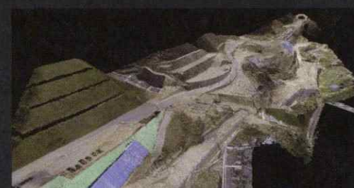
UAV（ドローン）等による3次元起工測量
