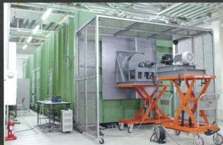
●送風機性能試験
