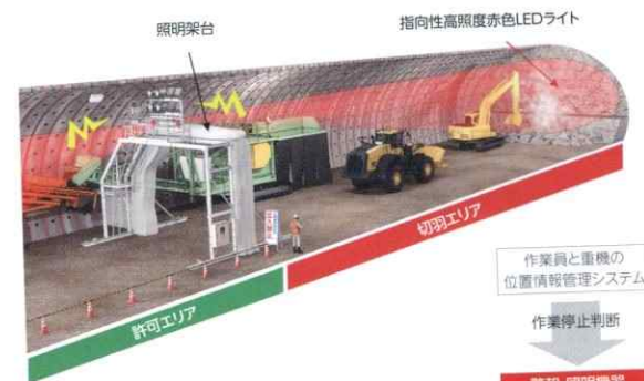
人と重機の接触災害リスク低減システム 熊本57号滝室坂トンネル西新設工事(熊本県菊池郡)
