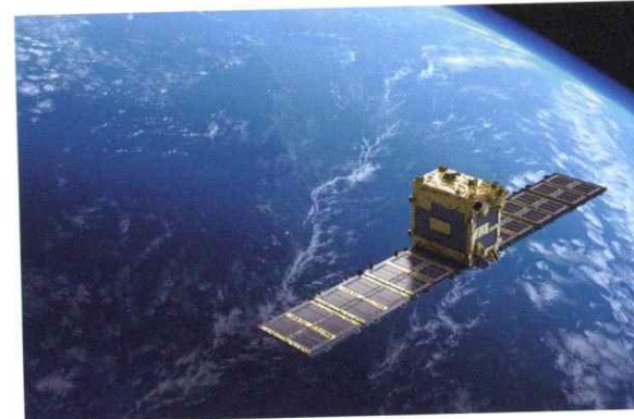
小型SAR衛星「Strix-α」((株)Synspective)
