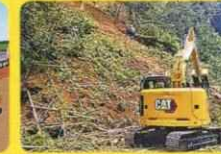
災害復旧にも役立つ建機。危険な現場では遠隔操作で安全な作業を支援
