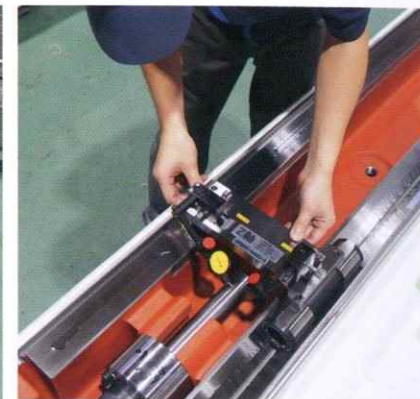
ボールねじ取付の芯出し
