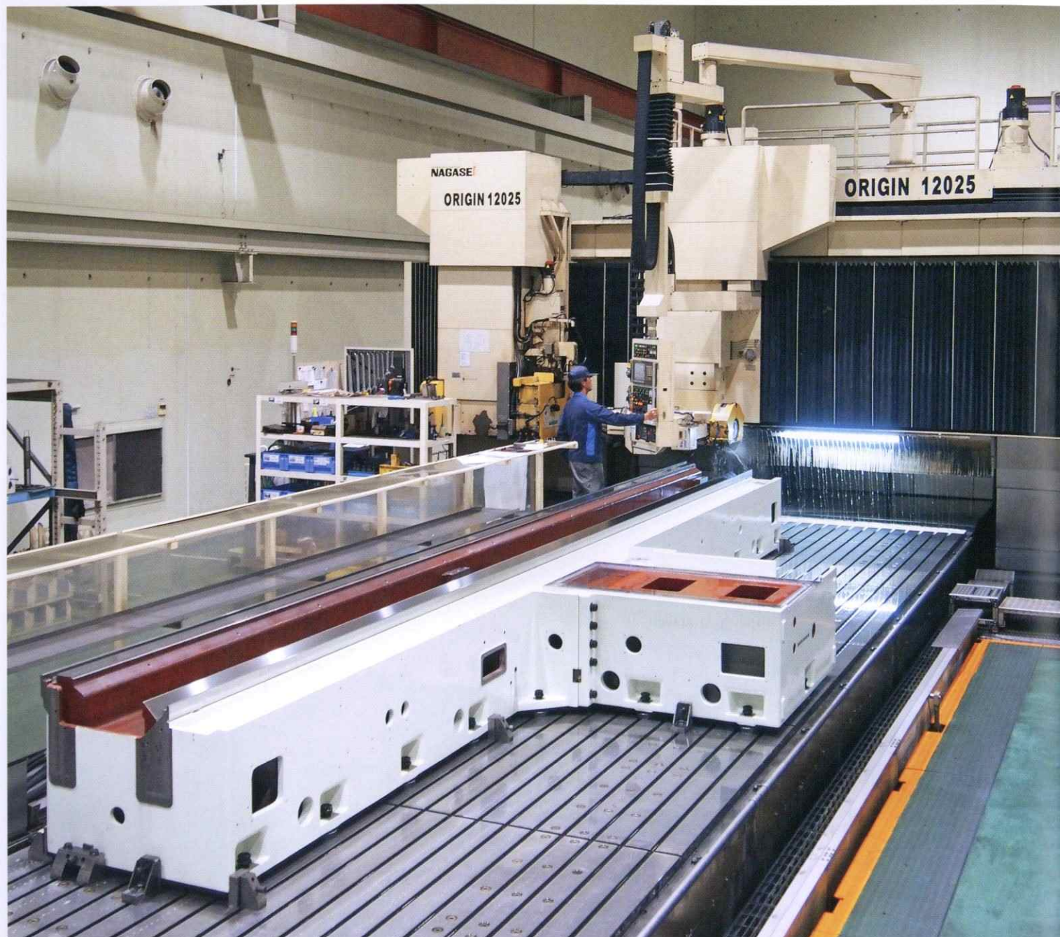
室温が±0.7℃以内にコントロールされた平研恒温エリア
