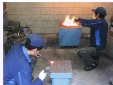
手づくりのシカラップをつくるため自社内に火造り場を設置
