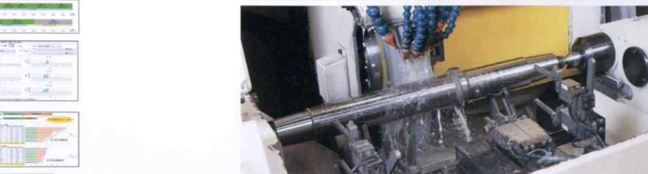
円筒研削盤の心臓部であるといし軸を真円度0.1μmに研削するCNC万能研削盤
