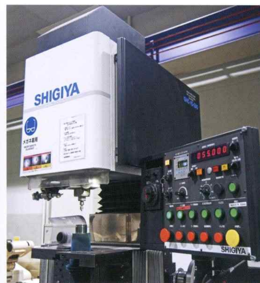
真円度0.1μmを目指しSHIGIYAが開発した超精密センタ穴研削盤によるいし軸のセンタ穴研削
