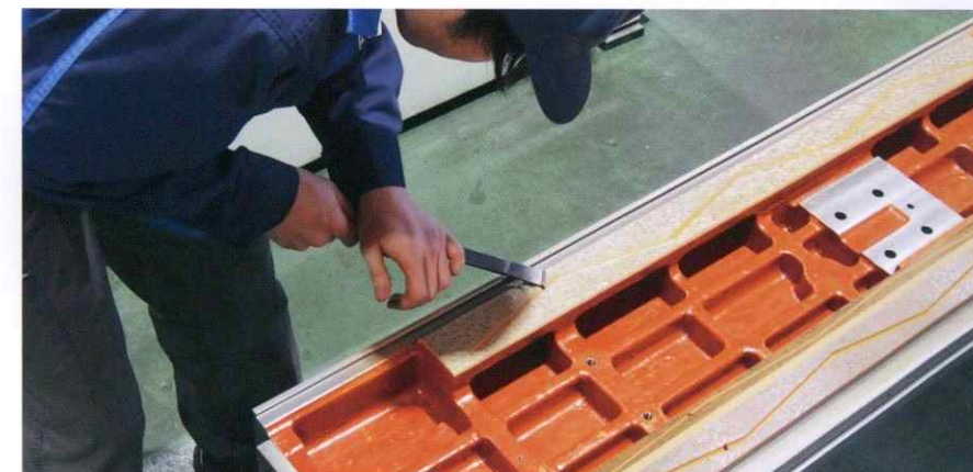
摺動面のキサゲ作業
