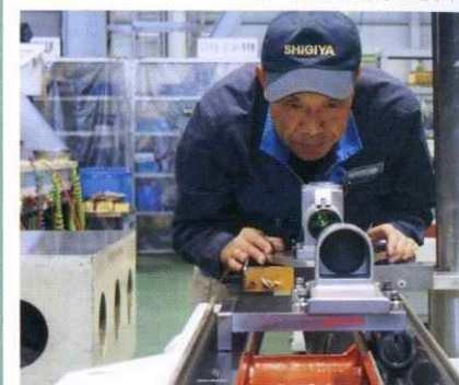
オートコリメータによる真直度測定
