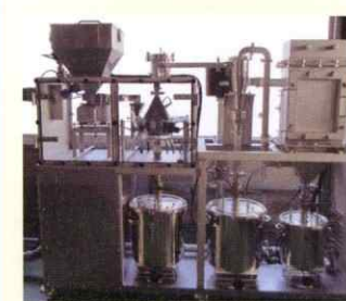
不活性ガス仕様分級設備
