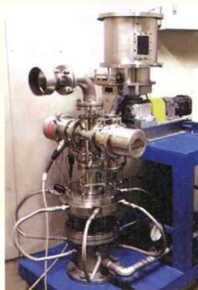
オンライン粒子モニター付粉砕設備
