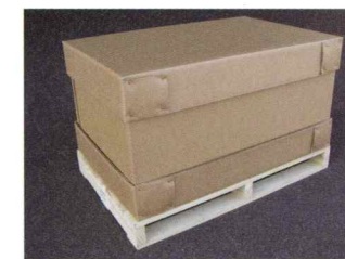
強化ダンボール梱包 現地での開梱や廃棄物の処理が容易にできますが、湿気、水に弱い点があります。航空便には有利です。
