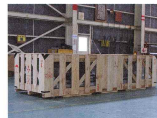
枠組み木箱梱包 重量貨物に適しています。中の見えない密閉木箱と中の見える透かし木箱があります。在来船での輸送に適しています。JIS Z1403 規格あり。
