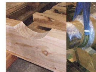
R台梱包 ロール製品、長尺軸等の梱包に適しています。
