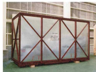
スチール梱包 大型貨物に適しています。木箱に比べて容積を小さくできます。廃棄物の処理も可能ですが、加工が容易ではありません。
