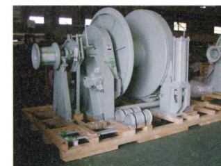
スキット梱包 木箱のように周囲を覆わず、SKID に製品を固定しただけの梱包方法。安価ですが、傷つきやすいデメリットがあります。海上コンテナ輸送に向いています。
