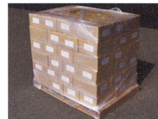
パレット梱包 カートなどを積みストレッチフィルム等で固定します。SKID 梱包同様に安価にできます。
