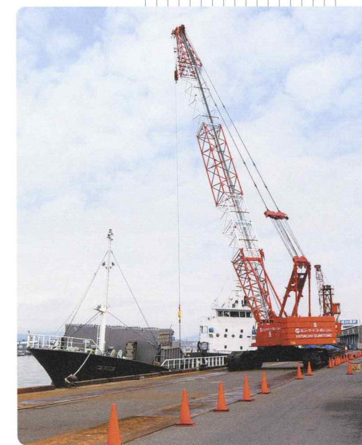
120トンクローラクレーン車
