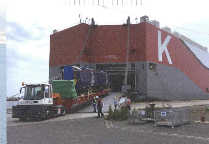
高速鉄道車両積込作業
