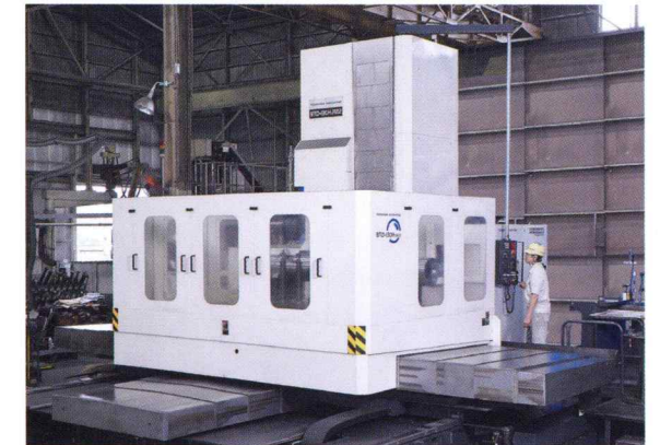
NC 横中ぐりフライス盤 / NC horizontal boring machine
