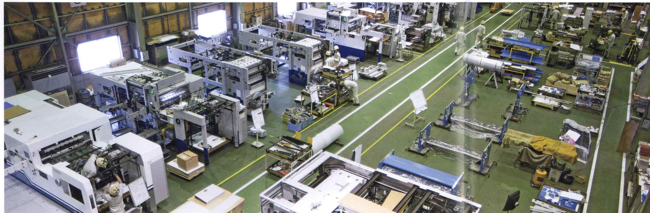
自動平盤打抜機ライン The assembly line of the automatic platen cutting and creasing machine
