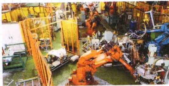
■ロボットによる自動溶接ライン Automated Welding Line with Robots
