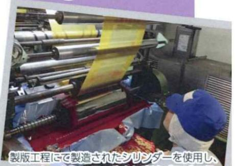
製版工程にて製造されたシリンダーを使用し、インフレーションフィルムに高速グラビア印刷を行うための機械のセットや、色味の調整等を行います。
