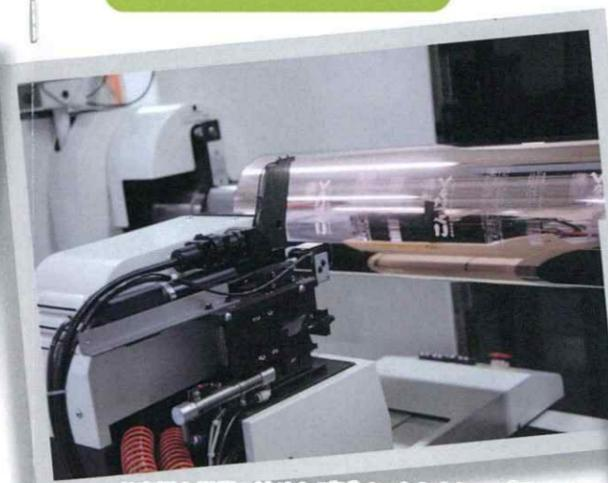
お客様と営業で決めたデザインをもとに、グラビア印刷用の版を製造するため、ダイヤモンドの針を使用して直接シリンダーへ図柄を彫刻していきます。
