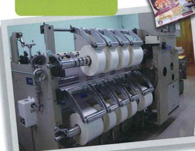
検品では、フィルムに異物が無いかを検品機にて確認を行います。スリッターでは、フィルムを指定された幅にカットし、加工しやすい状態に形を変えます。
