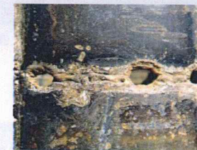
溶接不良でピンホールが水食によって大きくなった穴あき状況
