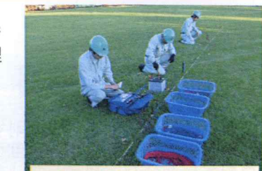
電気探査による水源調査
