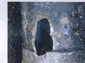
溶接不良でピンホールが水食によって大きくなった穴あき状況
