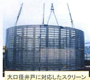
大口径井戸に対応したスクリーン
