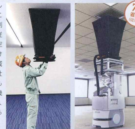
(左) 手作業による風量測定 (右) 自律走行型ロボットによる風量測定
