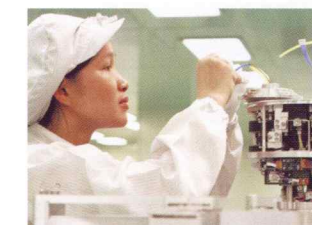
ロボットの組み立て(クリーンルーム) Assembly of robot (Clean room)
