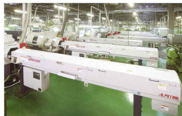
CNC自動旋盤ライン CNC automatic lathe line
