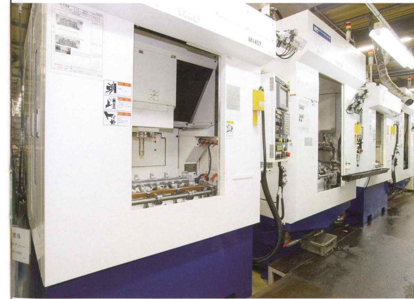
立形マシニングセンターライン Standing machining center line
