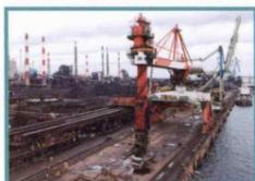
港についた船の中から原料を取り出し、ベルトコンベアなどで高炉まで輸送します。
