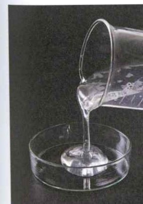
CNF:木材繊維(パルプ)をナノ化(微細化)した新素材
