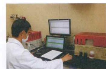
現地で採取した試料(汚染された土や水)を使用予定の薬剤で試験し、汚染の濃度経過を測定。結果によって浄化工法の提案をしている。
