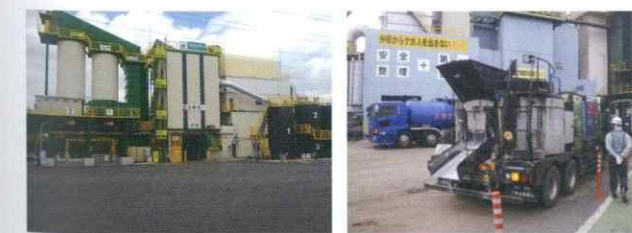
スマートグースを製造するプラント スマートグースを運搬するアスファルトクッカー車
