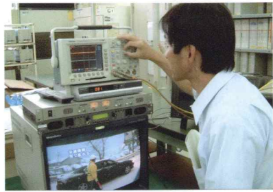
◆地デジ放送装置調整検査
