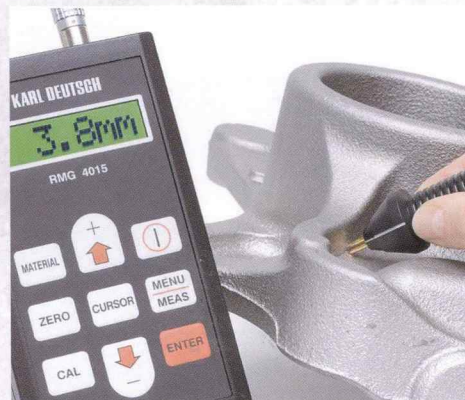
鋳物の割れ深さを測定
