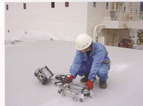
コンテナ輸送船甲板溶接線のTOFD法による検査
