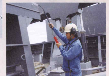
船倉溶接線の気密検査
