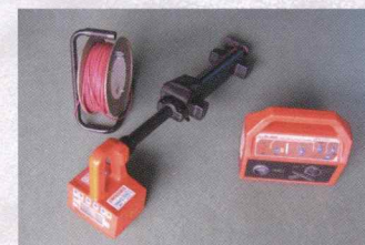
鉄管ケーブル探知機(電磁式)
