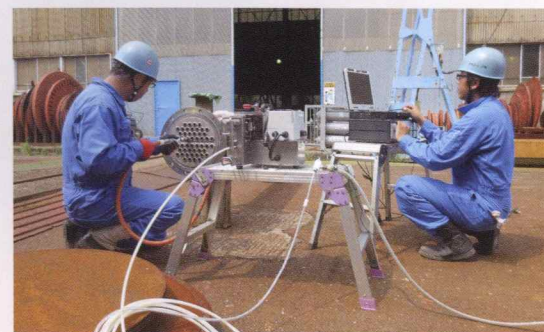
IRIS装置を用いた熱交換器伝熱管の検査風景
