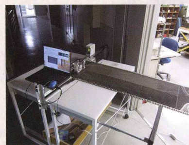
プレート熱交の板厚測定システムと表示部
