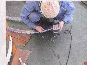
脱磁後に残留磁気を確認
