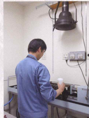
定置式磁粉探傷器による検査作業
