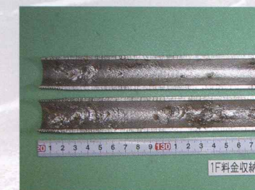
酸洗後に腐食状況を確認
