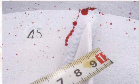
染色浸透探傷試験による割れの指示模様
