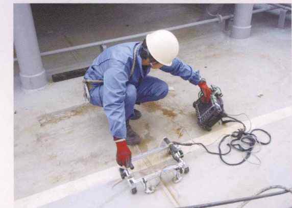
TOFD法の走査治具と専用超音波探傷器
