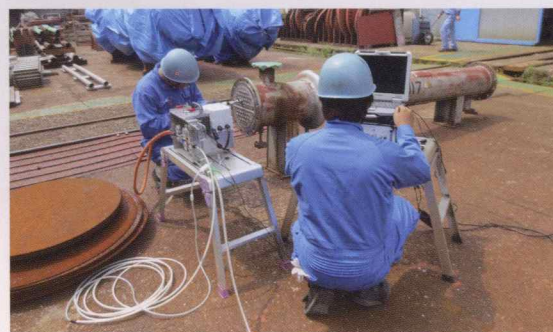
IRIS装置を用いた熱交換器伝熱管の検査風景
