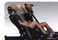
後面衝突頸部 保護性能試験
