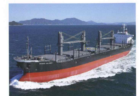
■貨物輸送船(バラ積み船) Small Handy 主要諸元 ●全長/169.4 m ●全幅/27.2 m ●喫水/9.8 m ●載貨重量/28,200 MT Supramax 主要諸元 ●全長/189.9 m ●全幅/32.2 m ●喫水/12.9 m ●載貨重量/58,100 MT
