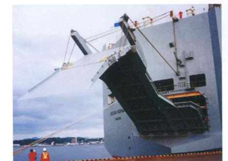
■RO/RO (Roll On Roll Off) 装置 パワーランプ、スターランプ、ドア、カーデッキ及びリフター等を組み合わせて貨物(車両)を船内に効率良く積み込むための装置です。最先端の技術によるコンピュータ制御も行います。
