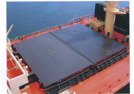
■ハッチカバー 貨物船の最も重要となる荷役のための船体開口部を覆い、風雨や海水の浸入から防ぐための鋼製のカバーです。カバー上に貨物を積載して輸送量を増加させることもできます。
