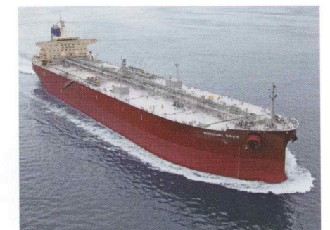
■石油製品運搬船(プロダクト船) MR 主要諸元 ●全長/182.5 m ●全幅/32.2 m ●喫水/12.6 m ●載貨重量/47,407 MT LR-I 主要諸元 ●全長/219.0 m ●全幅/38.0 m ●喫水/13.8 m ●載貨重量/79,995 MT LR-II 主要諸元 ●全長/244.4 m ●全幅/41.1 m ●喫水/14.6 m ●載貨重量/110,000 MT
