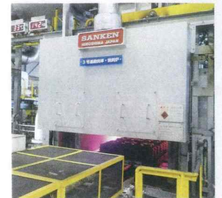
月見工場で行っている素材熱処理とは、機械加工前の素形材部品に対し、均質化・塑性加工・鍛造時の応力緩和・被削性向上（軟質化）・靱性向上といった特性を与えることを目的とした加工。素材熱処理は自動車などの部品製造において、重要な工程の一つです。株式会社ナガトでは、県内外に8カ所、中国とタイに各1カ所の計10カ所の工場が稼働している。
