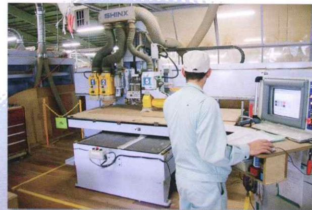
NC機械による曲線加工 Curve processing on NC machine
