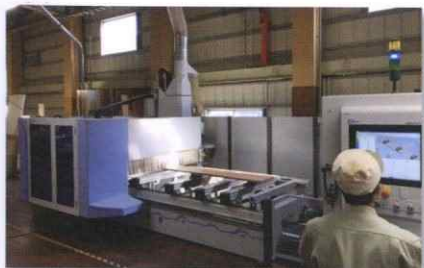
CNC機械による縁張加工 Edge banding with CNC machine
