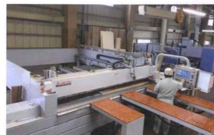
ランニングソー ベニヤ切断 Veneer cutting with running saw
