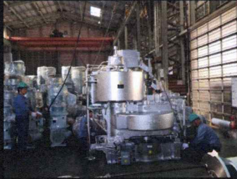
カーゴオイルポンプ駆動用タービン
