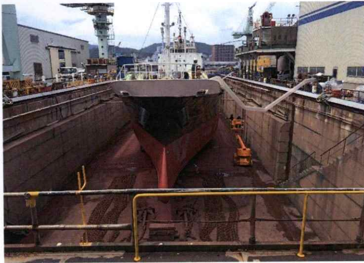
■ 2号ドック (1600G/T 渠底長:L85.5m×W17.0m)
