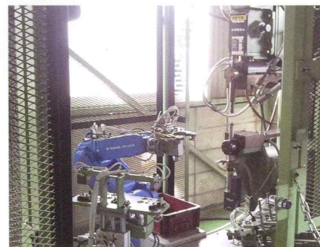
ナットプロジェクション溶接自動機 Nut Projection Automatic Welding Machine
