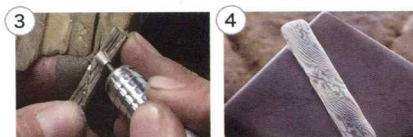
① 金属をあわせ層状の素材を作成 ② ねじりのぼす ③ 彫りを加える ④ さらに叩いて伸ばすと、木目金の板ができます
