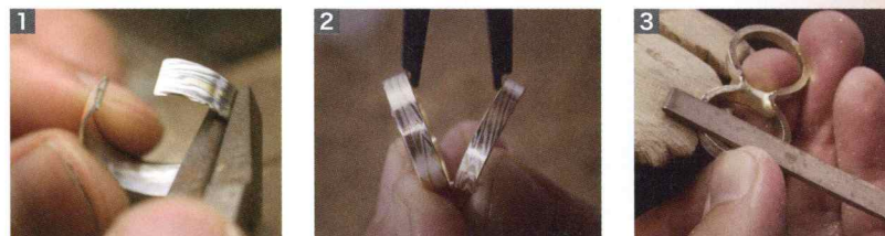
1 木目金の板を丸めてリング状にします 2 リング状にした板を二つに分けます 3 つながったまま、ふたつのリングができます
