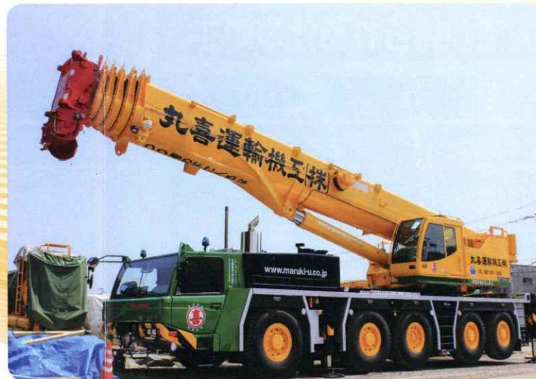
160t吊クレーン (車庫にて)
