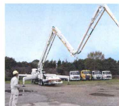
コンクリートポンプ車のブーム動作テスト
