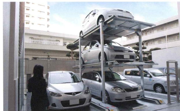
地下ピット式駐車装置 (昇降式)
