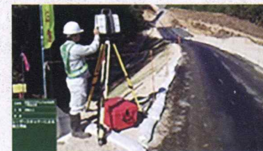
▲レーザースキャナーによる測量
